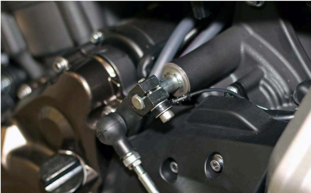
*Fixation du capteur du QSE avec une rondelle au dessus et en dessous*
