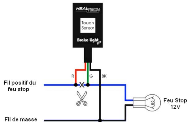
**Impératif : respecter le sens des branchements : Fil vert du Brake Light Pro sur le fil coupé coté ampoule, fil rouge sur le fil coupé coté faisceau de la moto (comme sur le schéma ci-dessus).**
