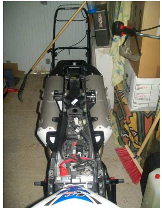
2) Démontez le couvre réservoir et maintenez le réservoir surélevé, cela suffit pour avoir accès aux branchements.
